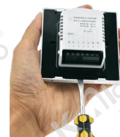
2、将插接排线解开(勿用力拉扯, 防止扯断), 将控制面板取下。
